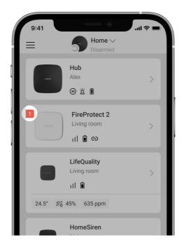
Si se detecta un fallo de funcionamiento del FireProtect 2 (por ejemplo, no hay conexión con el hub), el contador de fallos de funcionamiento se muestra en el campo del dispositivo en apps Ajax.
