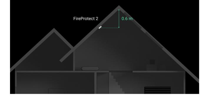
No recomendamos instalar el detector en la pared. Este tipo de instalación es aceptable si las vigas colocadas cerca u otros obstáculos interfieren con la instalación del detector. Solo se puede instalarlo en la pared si el detector se coloca a una distancia de 15–30 cm por debajo del techo pero encima de las puertas.
