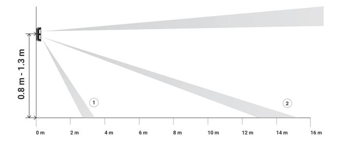
La distancia de detección se ajusta mediante la barra de desplazamiento **Distancia de detección (Detection Distance)** ubicada en el panel trasero del detector. Al elegir la ubicación de instalación, tenga en cuenta el rango máximo de detección del detector. Depende de la sensibilidad, la posición de la barra de desplazamiento de distancia de detección, el tipo y la velocidad del movimiento de las personas (correr, caminar) y la temperatura ambiente.
