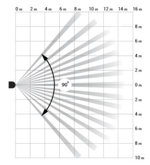
Asegúrese de que ningún obstáculo bloquee la visión del detector. Tenga en cuenta que MotionCam Outdoor no detecta movimiento detrás del vidrio. Por lo tanto, no instale el detector en lugares donde una ventana o puerta abierta pueda obstruir la visión.
