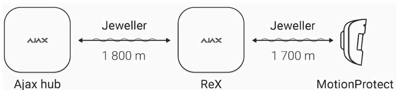
El rango de comunicación entre ReX y el dispositivo está limitado por el rango de la señal de radio del dispositivo (indicado en las especificaciones del dispositivo en la página web oficial [ajax.systems](http://ajax.systems) y en el Manual de usuario).
